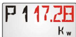
Potenza attuale del contatore della quantità di calore 1 in kW. Nel caso di visualizzazioni a 4 cifre, lampeggiano „P1“ ed il valore „17,28“ alternativamente.
