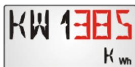
Quantità di calore contata del contatore della quantità di calore 1 in kWh. Nel caso di visualizzazioni a tre cifre, lampeggiano „KW1“ ed il valore „385“ alternativamente.
