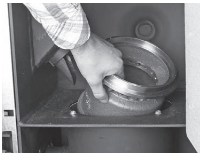
Fig. 34 Estrarre il cono parte inferiore
