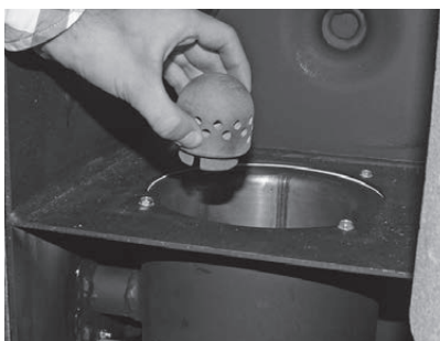
Fig. 38 Estrarre la spina aria primaria
