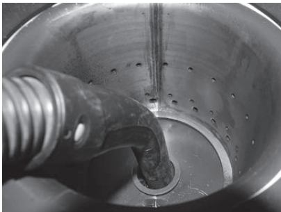
Fig. 41 Aspirare il tubo aria primaria al centro del corpo caldaia
