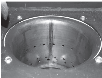
Fig. 40 Pulire i fori dell'aria secondaria nel corpo caldaia
