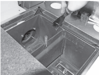
Fig. 50 Pulire le superfici riscaldanti
