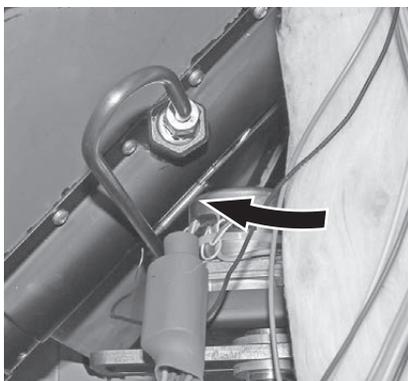
Fig. 47 Introdurre completamente la sonda per il termostato di sicurezza del tubo della coclea
