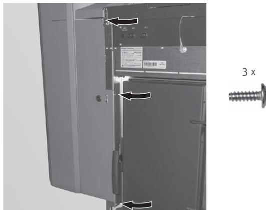
Fig. 68 Avvitare il rivestimento anteriore
