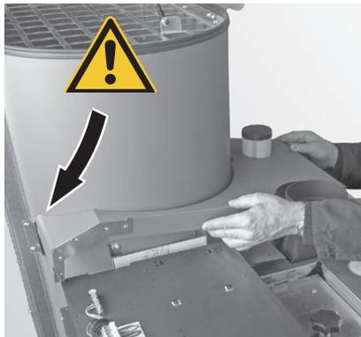
Fig. 76 Posare il rivestimento sinistro superiore con cautela
