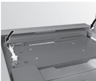
Fig. 116 Allentare le 2 viti del pannello di comando
