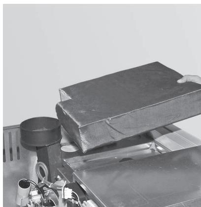
Fig. 31 Rimuovere l'isolamento
