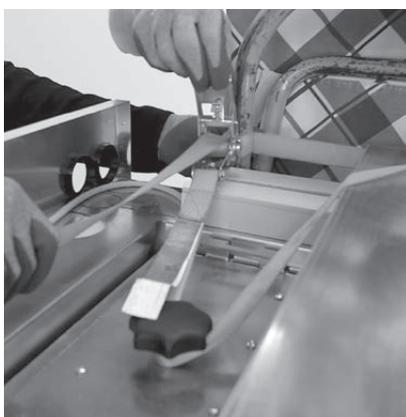
Fig. 13 Fissare la caldaia alla slitta con la cinghia elastica
