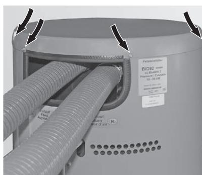
Fig. 105 Montaggio dei tubi flessibili di alimentazione e dell'aria di recupero
