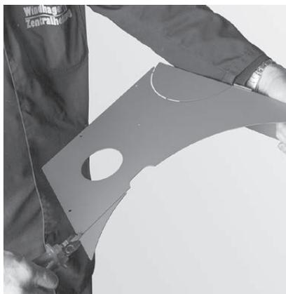
Fig. 74 Staccare con le tenaglie l'angolo del rivestimento sinistro superiore
