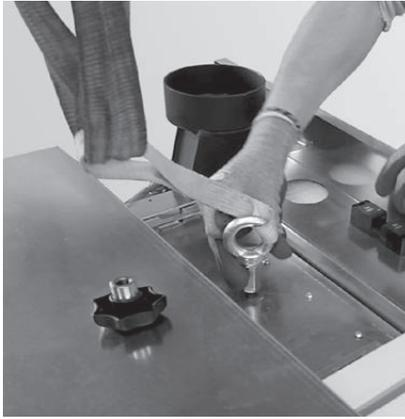
Fig. 15 Montaggio dell'occhiello (non compreso nella fornitura) per il gancio gru
