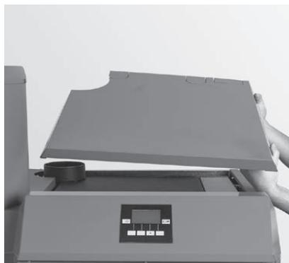
Fig. 133 Applicare il coperchio del rivestimento
