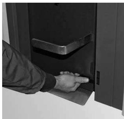
Fig. 111 Apertura staffa di fissaggio
