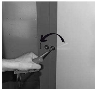
Fig. 116 Aprire la porta di copertura con la chiave
