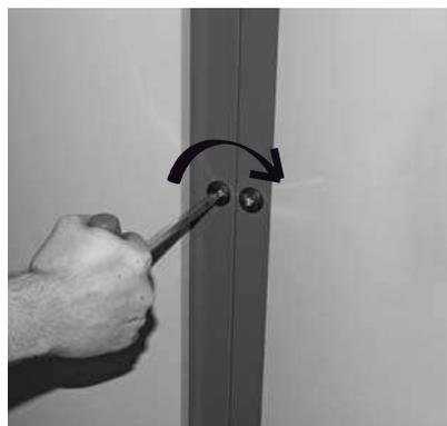
Fig. 109 Aprire la porta di copertura con la chiave
