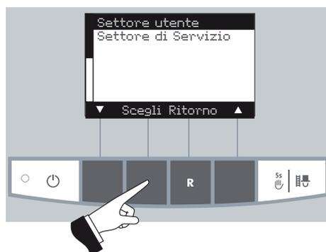
Selezionare con i tasti *freccia* il sottopunto "Tipo funzionamento convogliamento" – Fig. 70, e confermarlo con il tasto "Scegli" – Fig. 71.
