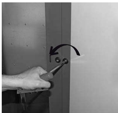
Fig. 121 Aprire il portello di copertura con la chiave.
