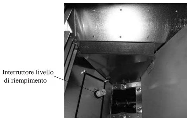
Fig. 139 Rimuovere la polvere dalla parte inferiore dell'interruttore livello di riempimento
