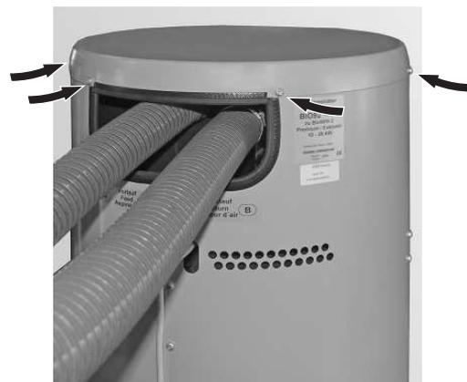
Fig. 78 Montaggio dei tubi flessibili di alimentazione e dell'aria di recupero
