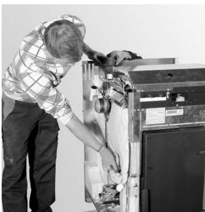
Fig. 11 Posizione della maniglia sul tubo della coclea e sul manicotto per il tubo di evacuazione fumi
