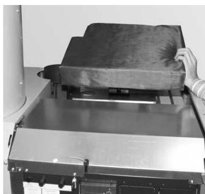
Fig. 90 Rimuovere l'isolamento
