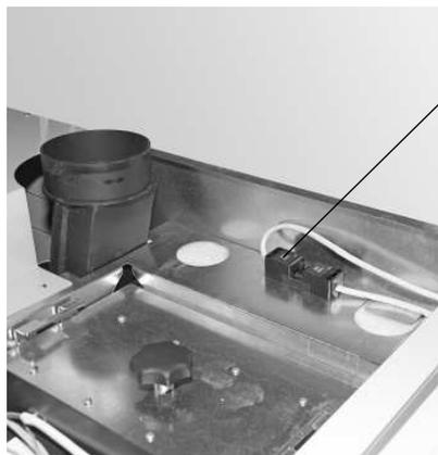
Fig. 96 Sfilare la spina di rete dell'apparecchio
