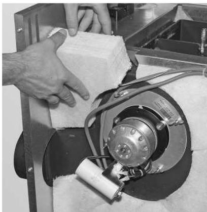
Fig. 34 Applicare l'isolamento (incluso, posto di lato sotto il ventilatore gas combusti)
