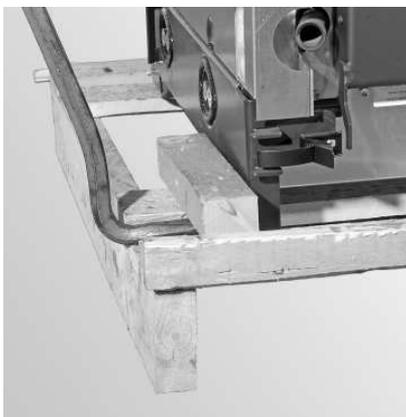
Fig. 9 Rimuovere la base laterale in legno
