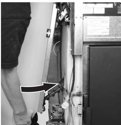
Fig. 36 Infilare la coclea di alimentazione in basso accanto al tubo della coclea
