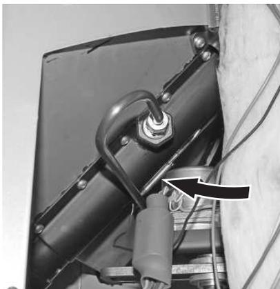
Fig. 42 Introdurre completamente la sonda per il termostato di sicurezza del tubo della coclea
