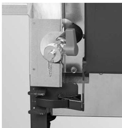
Fig. 25 Avvitare il rubinetto di riempimento e svuotamento (posizione della maniglia a destra) e reinserire la maniglia
