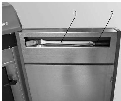
Fig. 80 Pennello per la pulizia e spatola all'interno della porta di contenimento
