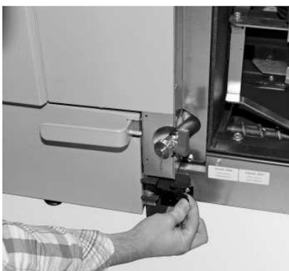
Fig. 74 Chiudere la chiusura a staffa di fissaggio
