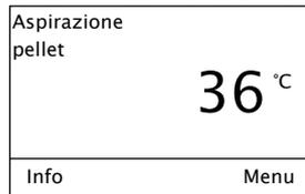
La caldaia passa in spegnimento prima dell'avanzamento del pellet. L'alimentazione può iniziare solo una volta che lo spegnimento è completato.
