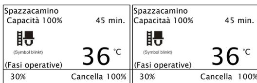
Premendo brevemente il pulsante della modalità manuale / spazzacamino sul modulo display, la modalità operativa passa alla funzione spazzacamino. Inizialmente, la capacità della caldaia è impostata al 100%. La capacità può essere impostata su 100% o 30% sul modulo display.
