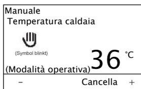
La modalità operativa manuale si avvia se il pulsante della modalità manuale / spazzacamino si trova sul il modulo display viene premuto per 5 secondi. La temperatura impostata della caldaia è impostata su 60 ° C e può essere variata tra 60 e 75 ° C. Se è disponibile ed è stato acceso, è possibile richiedere l'alimentazione del pellet.
