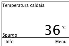
Se è presente un fabbisogno di calore e la temperatura della caldaia è <della richiesta di isteresi riscaldamento (l'impostazione di fabbrica è 5K, che può essere regolata tra 0K e 20K sul modulo display), la caldaia passa alla fase operativa di spurgo.
