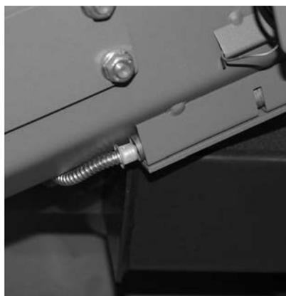
Fig. 179 Collegamento sonda per protezione dal ritorno di fiamma sulla coclea di dosaggio
