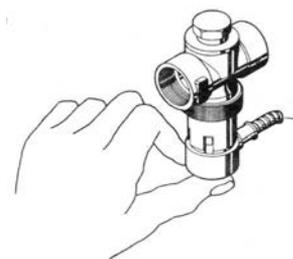
Fig. 208 Valvola di sicurezza scarico termico, premere il tappo rosso contro la valvola
