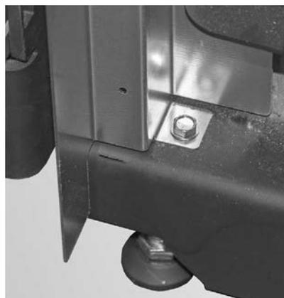
Fig. 29 1 vite davanti sul basamento
