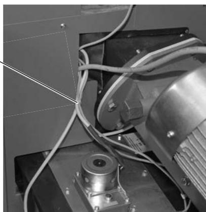
Fig.197 Unire i cavi con la fascetta per cavi
