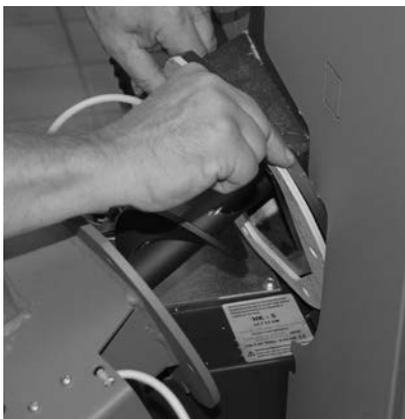
Fig. 102 Introdurre la coclea di dosaggio
