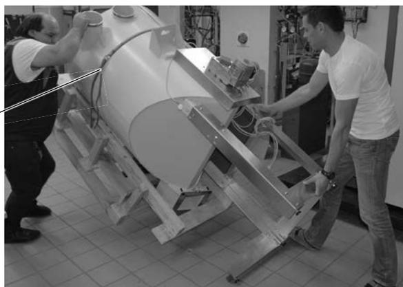
Fig. 149 Fissare la stiva al pallet con una cinghia elastica e portarli in verticale insieme
