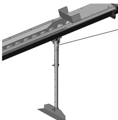
Ruotando la parte superiore, sollevare leggermente il prelievo dal magazzino, in modo che il piede d'appoggio sia ben saldo
