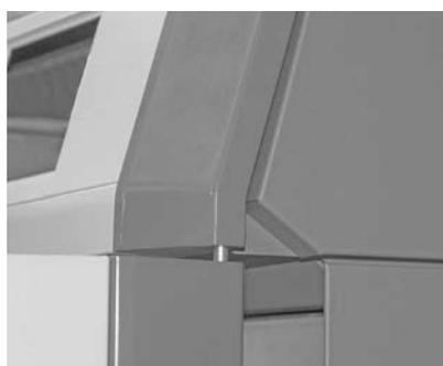
Fig. 80 Applicare il pannello di comando, agganciare la porta di contenimento al perno
