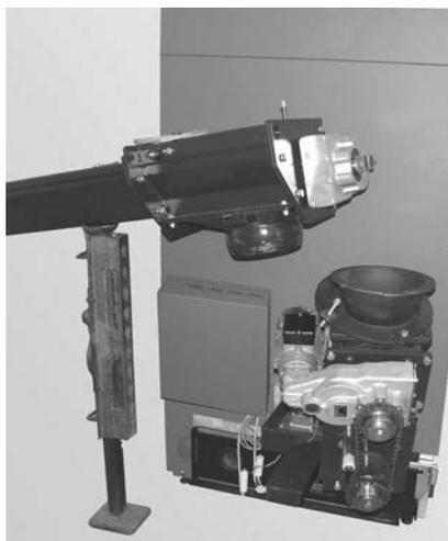
Fig. 133 Puntellare l'unità di trasferimento
