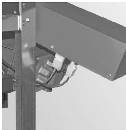
Fig. 157 Inserire le spine del quadro di comando 2 nell'elemento di chiusura
