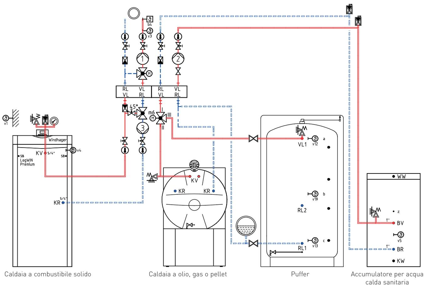
Fig. 54 Impianto idraulico: caldaia a combustibile solido, caldaia a olio, gas o pellet, accumulatore tampone e accumulatore per acqua calda sanitaria
