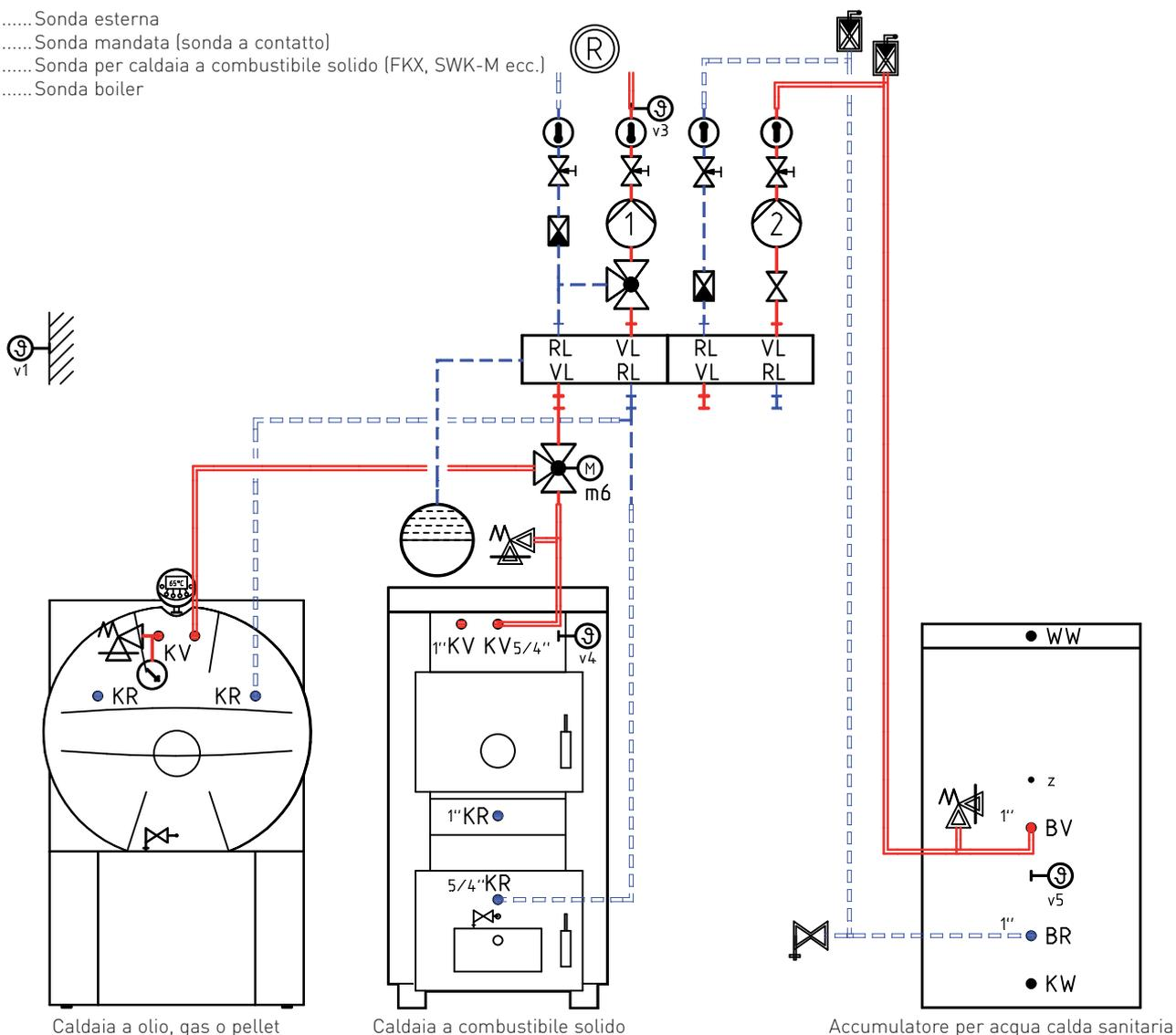
Fig. 53 Impianto idraulico: caldaia a olio, gas o pellet, caldaia a combustibile solido e accumulatore per acqua calda sanitaria
