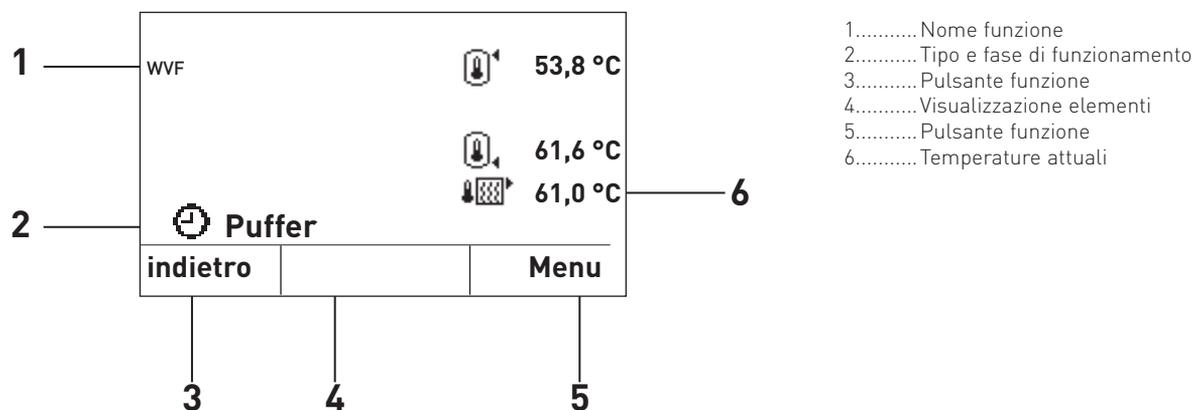
Fig. 3 Schermata del titolo del modulo funzionale WVF+
