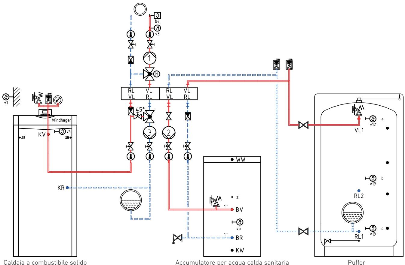
Fig. 52 Impianto idraulico: caldaia a combustibile solido, accumulatore tampone e accumulatore per acqua calda sanitaria
