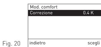
4. Nel display compare la nuova selezione. Per tornare alla schermata del titolo, premere più volte il pulsante "**indietro**", oppure dopo 5 minuti compare automaticamente la schermata del titolo e l'illuminazione del display si spegne.
