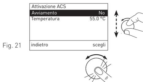
1. Ruotare la manopola di impostazione **"scegli"** per selezionare **"Avviamento"** o **"Temperatura"**.
