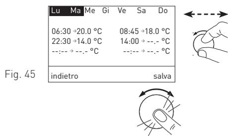
5. Nel display è sottolineato lunedì "Lu". Ruotando la manopola si può selezionare un giorno (sottolineato). Premendo si inserisce il giorno selezionato nella selezione (rappresentazione invertita) o lo si rimuove dalla selezione.
