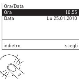
5. Per tornare alla schermata del titolo, premere più volte il pulsante "**indietro**", oppure dopo 5 minuti compare automaticamente la schermata del titolo e l'illuminazione del display si spegne.
