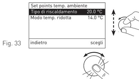
1. Ruotare la manopola di impostazione "scegli" per selezionare "Tipo di riscaldamento" o "Modo temp. ridotta".
