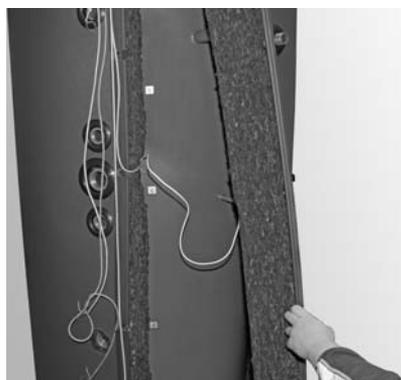
Fig. 49 Inserire i cavi sensore negli alloggiamenti
