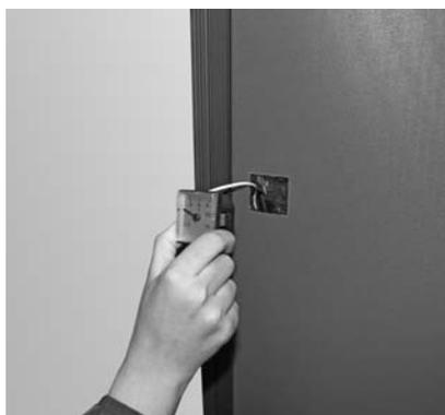
Abb. 48 Montaggio del termometro
