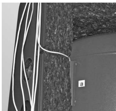
Abb. 44 Sonda introdotta per circa 3 cm nel canale sotto il rivestimento isolante.
