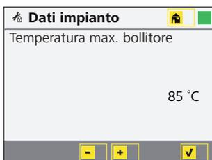
Vi è possibile regolare la temperatura massima per l'accumulo. Negli impianti con due accumuli questo valore si riferisce al primo accumulo.
