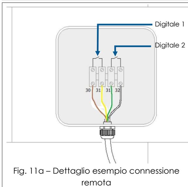
Fig. 11a – Dettaglio esempio connessione remota
