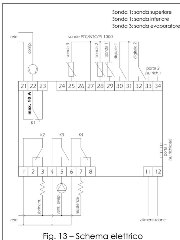
Fig. 13 – Schema elettrico
