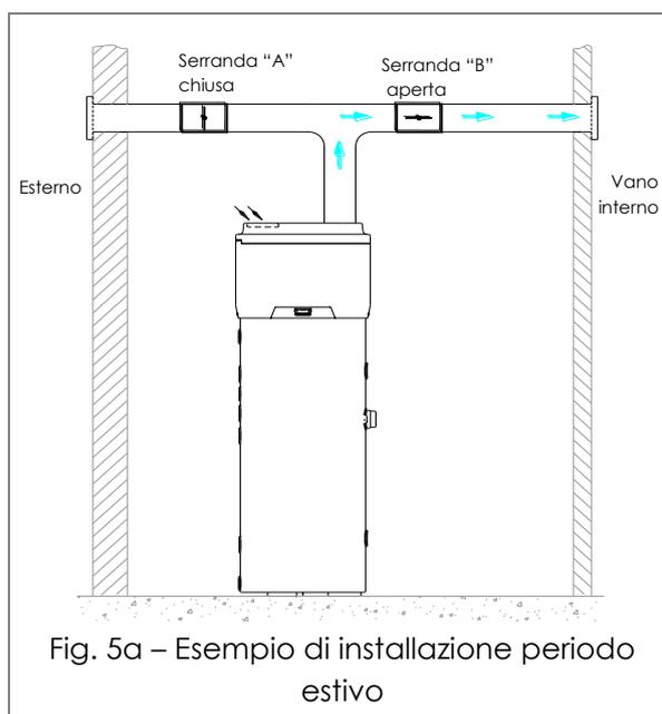
Fig. 5a – Esempio di installazione periodo estivo
