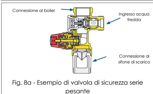
Fig. 8a - Esempio di valvola di sicurezza serie pesante
