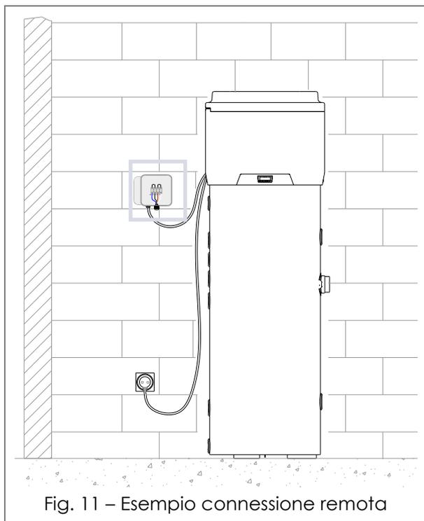
Fig. 11 – Esempio connessione remota
