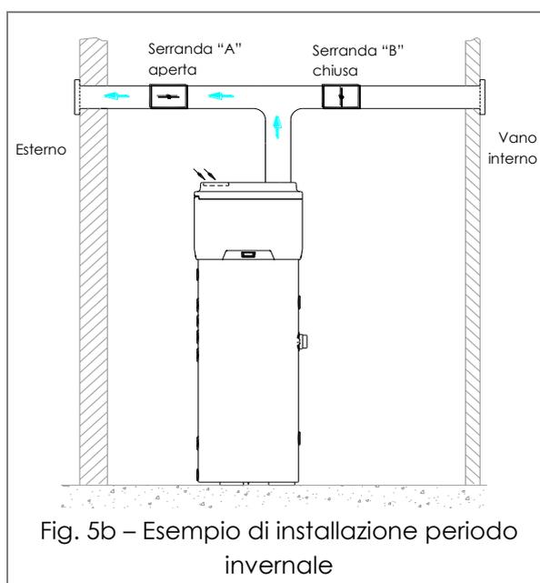
Fig. 5b – Esempio di installazione periodo invernale
