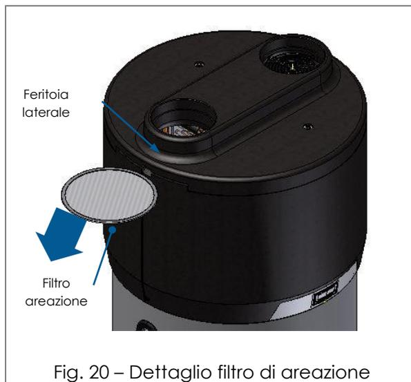
Fig. 20 – Dettaglio filtro di areazione
