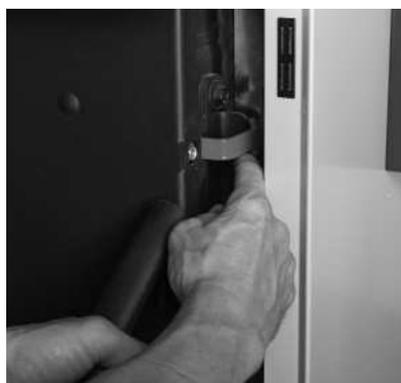
Fig. 13 Aprire il blocco dello sportello di riempimento.
