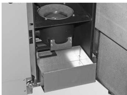
Fig. 46 Estrarre il recipiente per cenere e metterlo davanti alla caldaia
