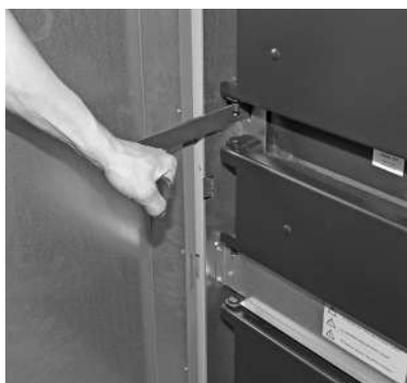
Fig. 12 Azionare la pulizia scambiatore a leva per circa 5 - 10 volte.
