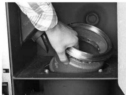
Fig. 55 Estrarre il cono parte inferiore
