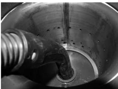
Fig. 62 Aspirare il tubo aria primaria al centro del corpo caldaia
