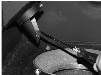
Fig. 52 Pulire il tubo di caduta
