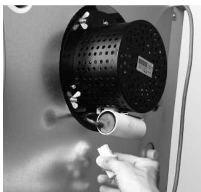
Fig. 34 Staccare la spina del ventilatore e rimuovere i dadi ad alette
