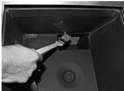
Fig. 51 Pulire la sonda Thermocontrol
