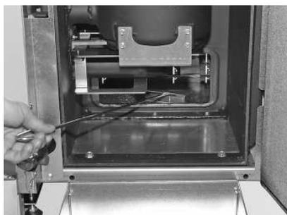
Fig. 48 Rimuovere la cenere sotto la superficie riscaldante nel cassetto.
