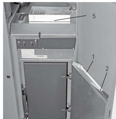
Fig. 26 Pennello per la pulizia e spatola all'interno della porta di contenimento
