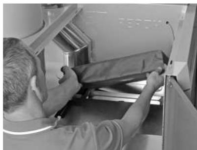
Fig. 67 Rimuovere l'isolamento
