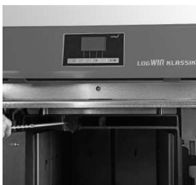
Fig. 32 Pulire l'aspirazione del gas distillato a bassa temperatura
