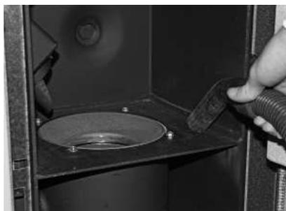
Fig. 53 Rimuovere i residui di combustione dalla camera di combustione
