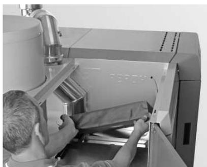
Fig. 145 Rimuovere l'isolamento
