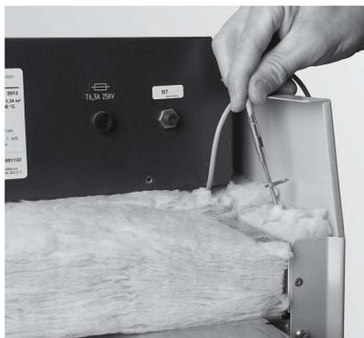
Fig. 46 Infilare la sonda Thermocontrol in alto
