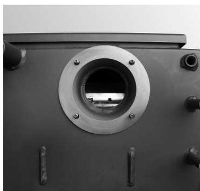
Fig. 21 Guarnizione sulla caldaia
