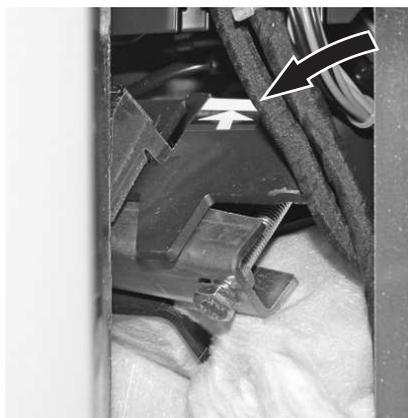
Fig. 86 Avvitare saldamente le viti di fissaggio in alto fino alla battuta (marcatura)
