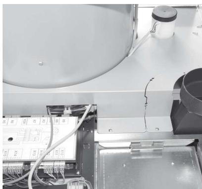
Fig. 150 Svitare la presa dal cavo, posare il cavo sotto il rivestimento superiore
