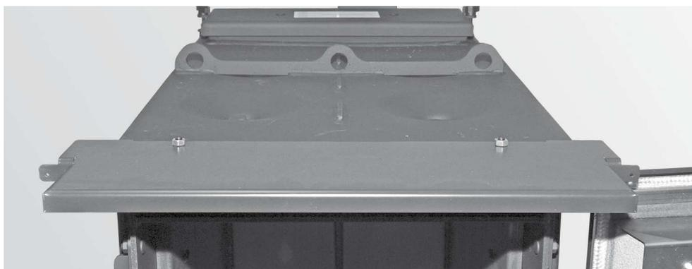
Fig. 33 Montare il condotto gas distillato a bassa temperatura
