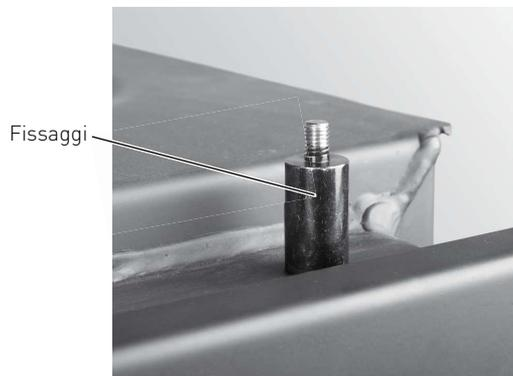
Fig. 31 Montare 2 fissaggi per condotto gas distillato a bassa temperatura
