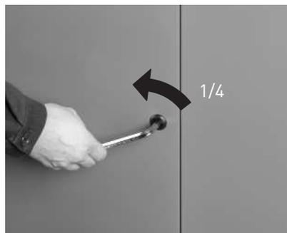
Fig. 142 Aprire la porta di contenimento con la brugola
