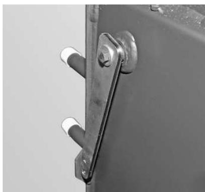
Fig. 36 Avvitare la leva corta
