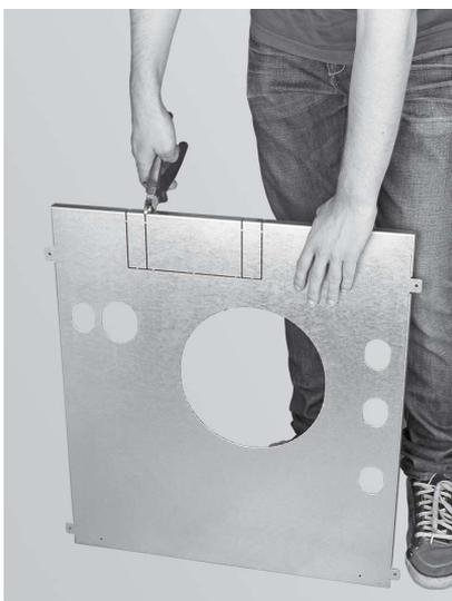
Fig. 56 Se non si utilizza alcun adattatore per raccordo gas combusti, staccare la prepunzonatura
