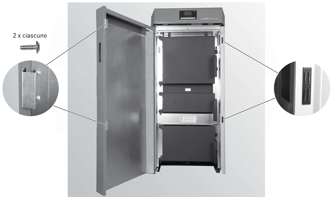
Fig. 68 Avvitare gli angolari alla porta di contenimento con 2 viti per lamiera ciascuno, inserire 2 cricchetti magnetici
