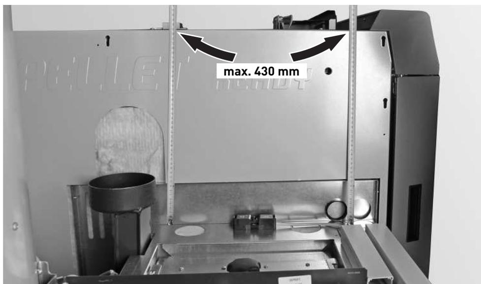
Fig. 101 Allineamento della caldaia a pellet
