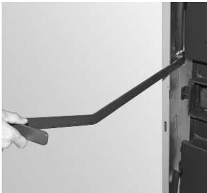
Fig. 59 Infilare la pulizia scambiatore a leva attraverso la fessura nella parete laterale
