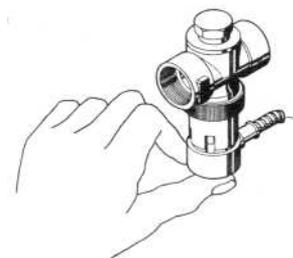
Fig. 161 Valvola di sicurezza scarico termico, premere il tappo rosso contro la valvola
