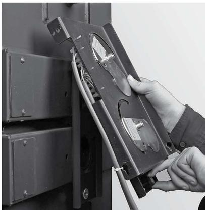
Fig. 26 Agganciare la regolazione aria in alto e avvitare sotto
