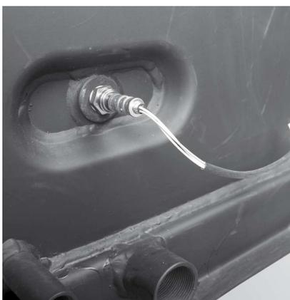
Fig. 27 Sonda Lambda montata
