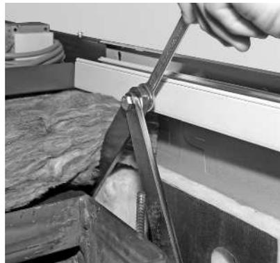
Fig. 60 Avvitare le due leve, non serrare, la tiranteria deve essere mobile
