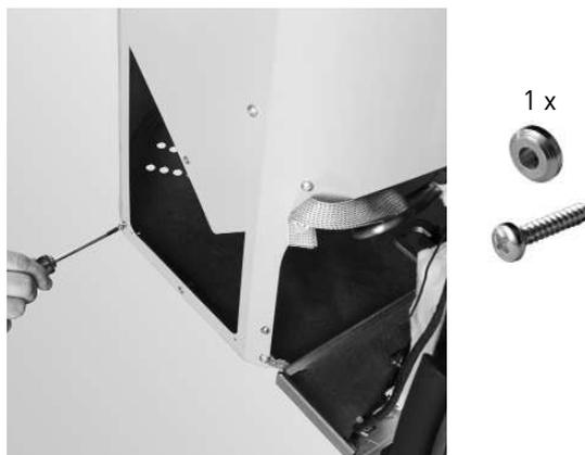
Fig. 110 Montare la chiusura a baionetta
