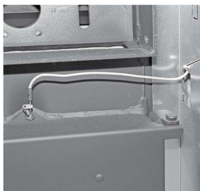
Fig. 49 Tirare indietro il cavo e fissarlo con la fascetta per cavi
