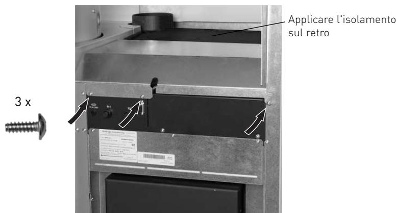
Fig. 125 Montare il coperchio del quadro di comando, applicare l'isolamento sul retro
