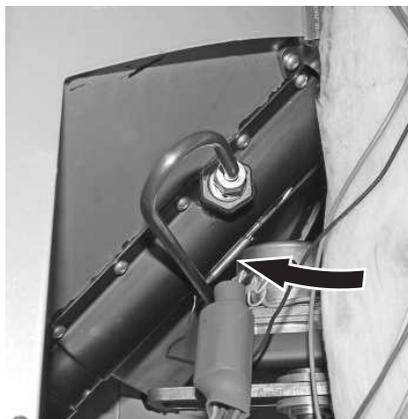
Fig. 90 Introdurre completamente la sonda per il termostato di sicurezza del tubo della coclea
