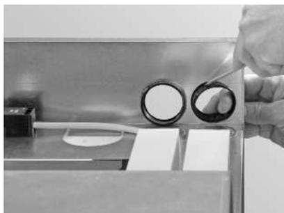
Fig. 99 solo con caldaia a pellet da 21/26 kW: Rimuovere il passacavo
