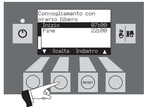
Premendo il tasto + o – l’orario può essere modificato ogni volta di 15 min. – Fig. 80.
