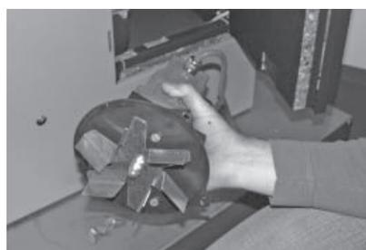
Abb. 155 Pulire il girante del ventilatore
