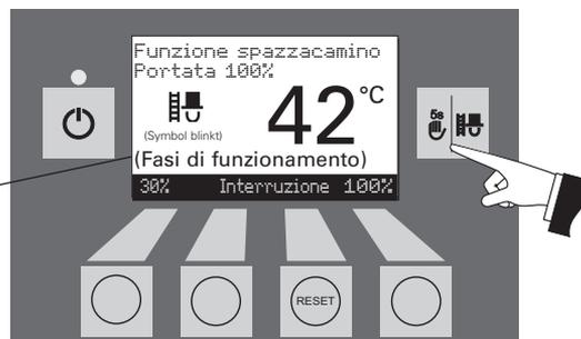
Premendo i rispettivi tasti Menu la caldaia può funzionare al 30% o al 100% di portata – Fig. 26. Quando, dopo 45 sec., si spegne il display la funzione resta invariata o anche la scritta. Premendo un qualsiasi tasto si accende di nuovo.
