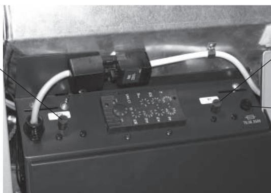
Cappuccio di copertura del termostato di sicurezza B7
