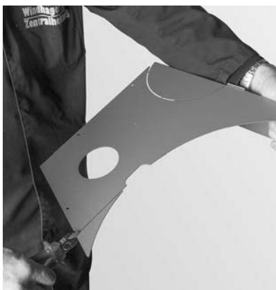
Fig. 30 Separar la esquina de la parte superior izquierda del revestimiento
