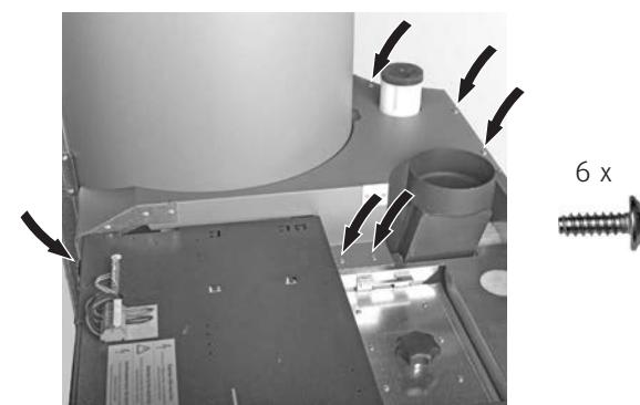
Fig. 33 Fijar el revestimiento con 6 tornillos de chapa
