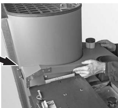
Fig. 32 Colocar cuidadosamente el revestimiento en la parte superior izquierda
