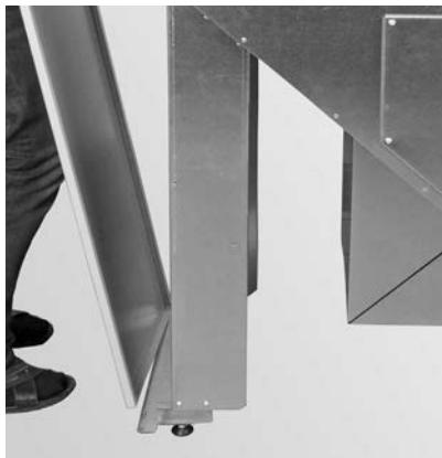
Fig. 36 Seitenwand links unten einhängen
