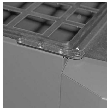
Fig. 39 Türscharnier mit eingehängter Verkleidungstür anschrauben
