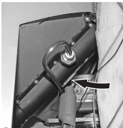
fig.15 Insérer la sonde pour le thermostat de sécurité du tube de vis sans fin
