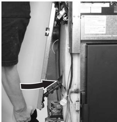
Fig.10 Förderschnecke unten bei Schneckenrohr einfädeln
