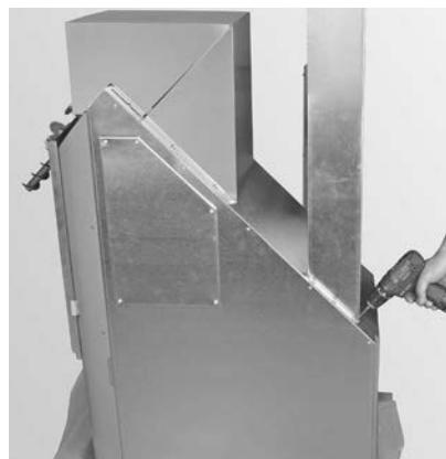
Fig. 7 6 Stk. Schrauben entfernen
