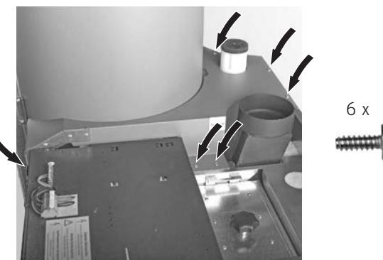
fig.33 Fixer le revêtement avec 6 vis à tôle
