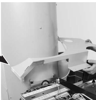
Fig. 31 Posare il rivestimento sinistro superiore con cautela.
