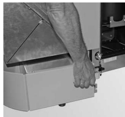
Fig. 40 Aschebox leicht schräg einschieben und Griff bei Aschebox ganz hineinschieben
