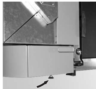
Fig. 42 Ajuster les vis de réglage
