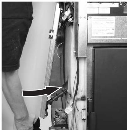
Fig. 9 Infilare la coclea di alimentazione in basso accanto al tubo della coclea
