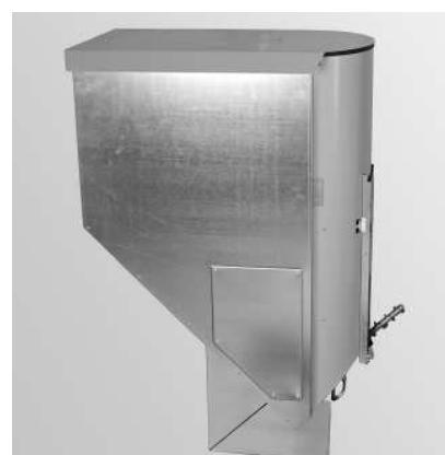
Fig. 8 Girar el contenedor para una semana hacia la posición correcta
