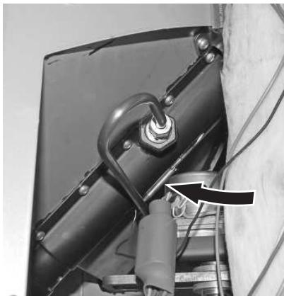
Fig. 14 Introdurre completamente la sonda per il termostato di sicurezza del tubo della coclea
