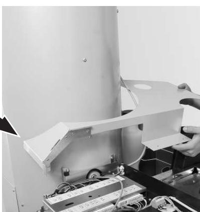
Fig. 31 Colocar cuidadosamente el revestimiento en la parte superior izquierda
