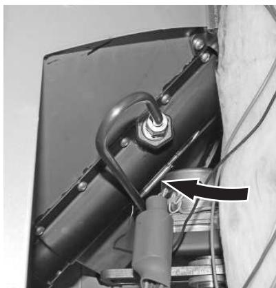
Fig. 14 Insertar del todo la sonda para el termostato de seguridad del tubo del tornillo sinfín
