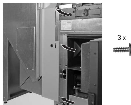
Fig. 34 Avvitare il rivestimento anteriore
