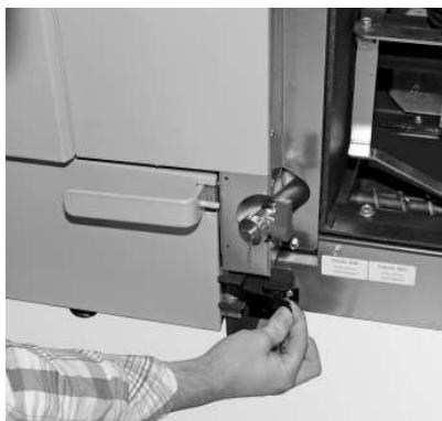
Fig. 41 Fermer le dispositif de fermeture à étrier de tension
