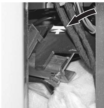
Fig. 11 Befestigung oben bis zum Anschlag (Markierung) festschrauben
