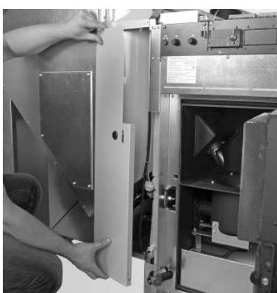
Fig. 33 Infilare il rivestimento anteriore
