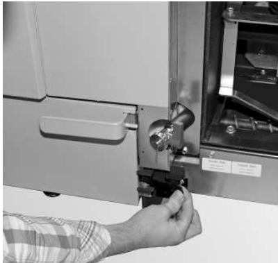
Fig. 41 Chiudere la chiusura a staffa di fissaggio
