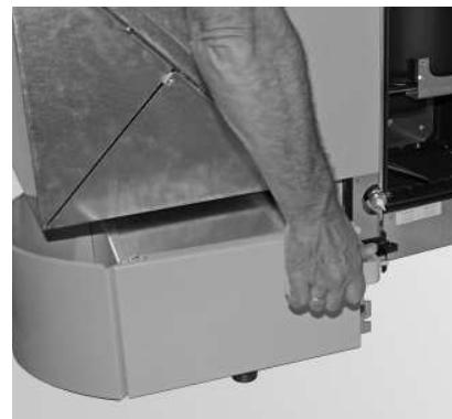
Fig. 40 Inserire il cassetto raccoglicenere spingendolo leggermente inclinato e introdurre completamente la maniglia nel cassetto
