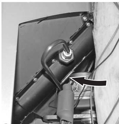
Fig. 14 Insérer la sonde pour le thermostat de sécurité du tube de vis sans fin
