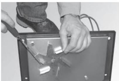
Fig.132 pulire girante ventilatore
