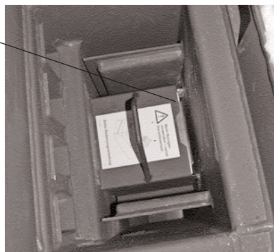
Fig. 52 - Unità di protezione sul cilindro di combustione.
