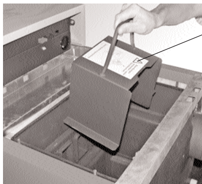
Fig. 51 - Montare l'unità di protezione.
