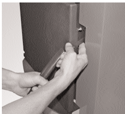
Fig. 37 - Aprire la chiusura del portello di riempimento.
