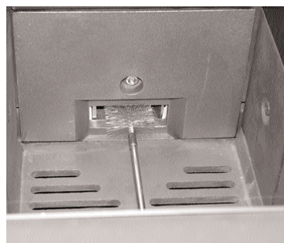
Fig. 44 - Pulire l'ugello aria secondaria.
