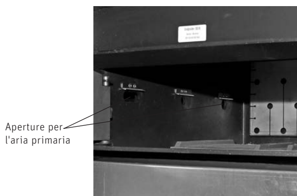
Fig. 39 Sganciare le lamiere ad aggancio; controllare le aperture per l'aria primaria.
