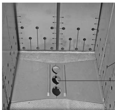
Fig. 7 Camera di riempimento, fori nelle lamiera ad aggancio, apertura per la combustione
