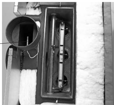
Fig. 37 Pulire le superfici riscaldanti superiori
