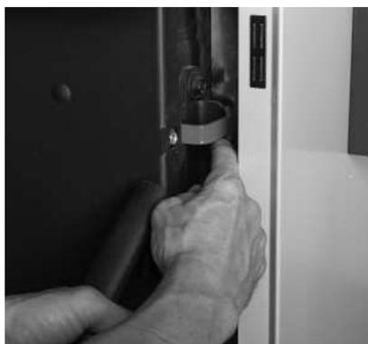
Fig. 51 Aprire il blocco dello sportello di riempimento.
