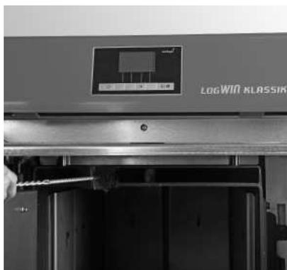
Fig. 66 Pulire l'aspirazione del gas distillato a bassa temperatura
