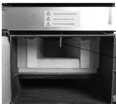
Fig. 73 Pulire la sonda Thermocontrol
