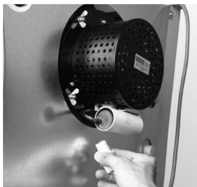
Fig. 68 Staccare la spina del ventilatore e rimuovere i dadi ad alette
