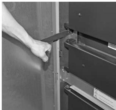
Fig. 50 Azionare la pulizia scambiatore a leva per circa 5 - 10 volte LogWIN Klassik pellet ready
