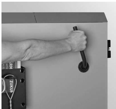
Fig. 49 Azionare la pulizia scambiatore a leva per circa 5 - 10 volte LogWIN Klassik
