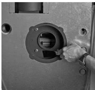
Fig. 70 Pulire l'interno della scatola del ventilatore
