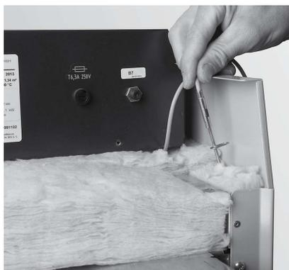
Fig. 35 Infilare la sonda Thermocontrol in alto
