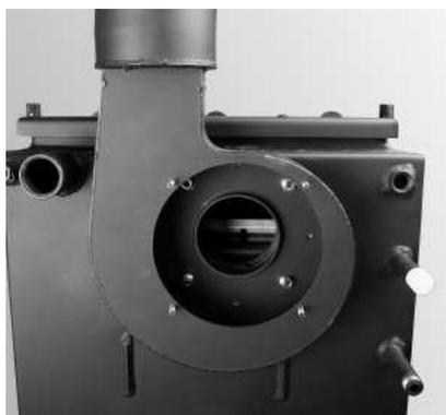
Fig. 10 Alloggiamento del ventilatore montato direttamente sulla caldaia, di serie
