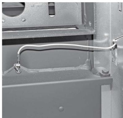
Fig. 38 Tirare indietro il cavo e fissarlo con la fascetta per cavi
