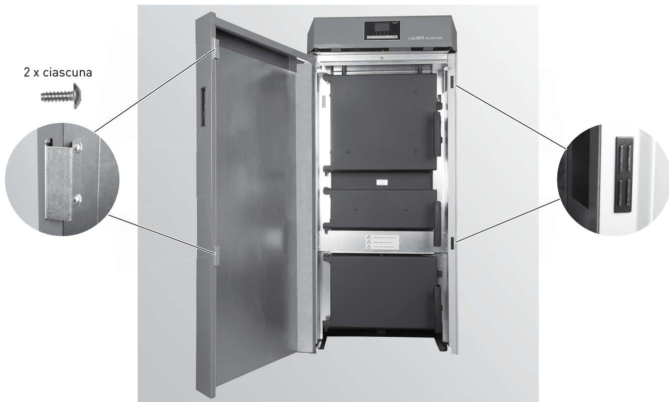
Fig. 59 Avvitare gli angolari alla porta di contenimento con 2 viti per lamiera ciascuno, inserire 2 cricchetti magnetici
