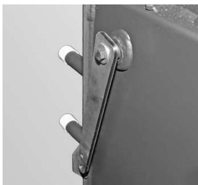
Fig. 24 Avvitare la leva corta
