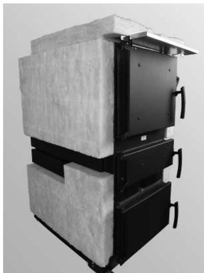
Fig. 28 Montare gli isolament (LogWIN Klassik)
