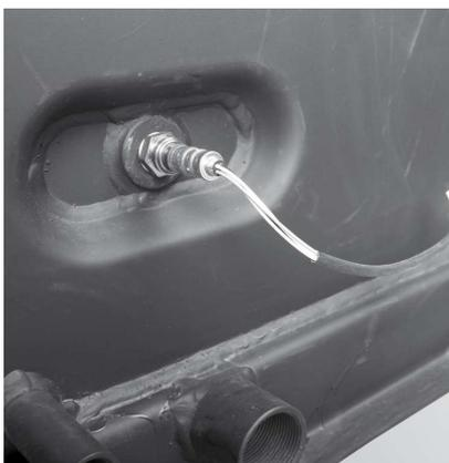
Fig. 15 Sonda Lambda montata
