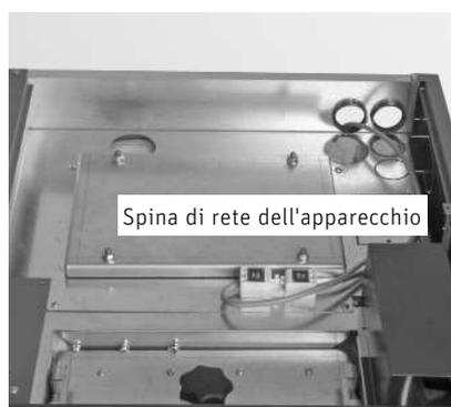
Fig. 107 Spina di rete dell'apparecchio in alto sotto la copertura
