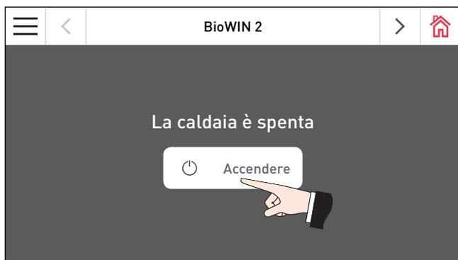
Fig. 53 Accensione caldaia
