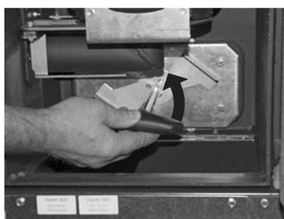
Fig.29 Ruotare la maniglia in senso antiorario
