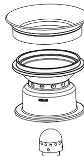
Fig. 48 Cono parte superiore e inferiore, spina aria primaria
