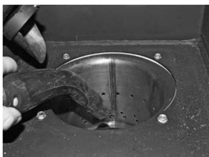
Fig. 43 Aspirare il corpo caldaia
