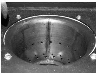
Fig. 46 Pulire i fori dell'aria secondaria nel corpo caldaia
