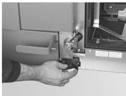
Fig. 31 Aprire la chiusura a staffa di fissaggio
