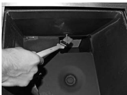
Fig. 36 Pulire la sonda Thermocontrol
