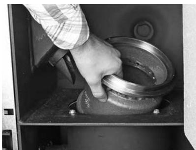
Fig. 40 Estrarre il cono parte inferiore
