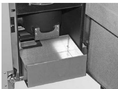
Fig. 26 Estrarre il recipiente per la cenere e metterlo davanti alla caldaia
