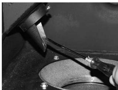
Fig. 37 Pulire il tubo di caduta
