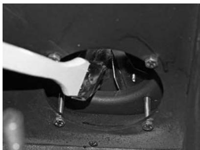
Fig. 55 Pulire e aspirare il ventilatore
