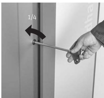
Fig. 6 Aprire la porta di contenimento con la chiave a brugola
