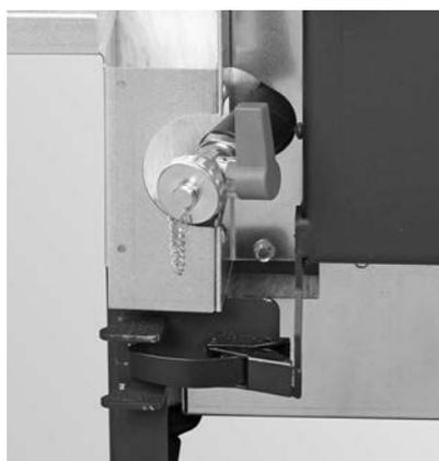
Fig. 22 Avvitare il rubinetto di riempimento e svuotamento (posizione della maniglia a destra) e reinserire la maniglia
