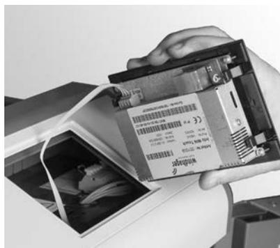
Fig. 65 Infilare il cavo di collegamento di InfoWIN Touch e inserire InfoWIN Touch nel pannello di comando (con il connettore rivolto verso l'alto)
