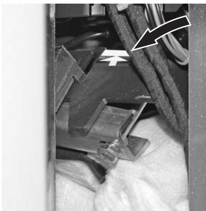
Fig. 35 Avvitare saldamente le viti di fissaggio in alto fino alla battuta (marcatura)
