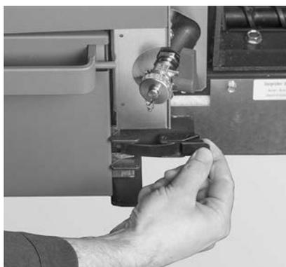
Fig. 71 Chiudere la chiusura a staffa di fissaggio
