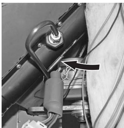
Fig. 39 Introdurre completamente la sonda per il termostato di sicurezza del tubo della coclea
