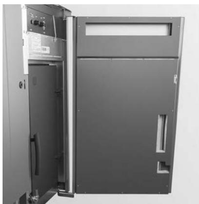
Fig. 62 Agganciare la porta di contenimento in alto e in basso
