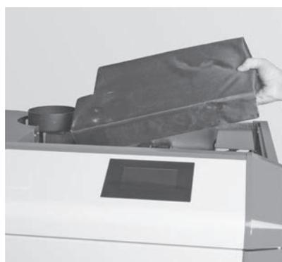
Fig. 99 Applicare l'isolamento
