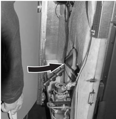
Fig. 33 Infilare la coclea di alimentazione in basso accanto al tubo della coclea
