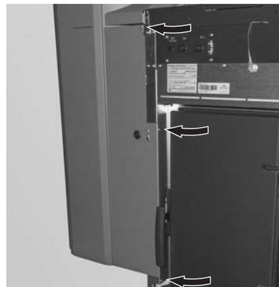
Fig. 55 Avvitare il rivestimento anteriore
