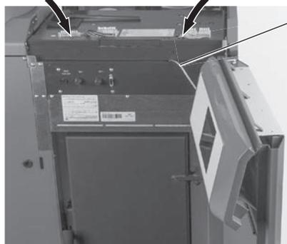
Fig. 88 Agganciare il pannello di comando alla porta (posizione di assistenza), aprire il coperchio
