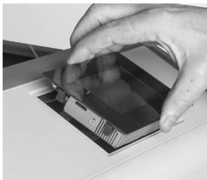
Fig. 66 Inserire InfoWIN Touch nel pannello di comando
