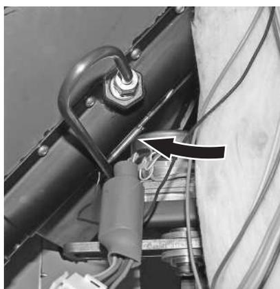
Fig. 41 Introdurre completamente la sonda per il termostato di sicurezza del tubo della coclea
