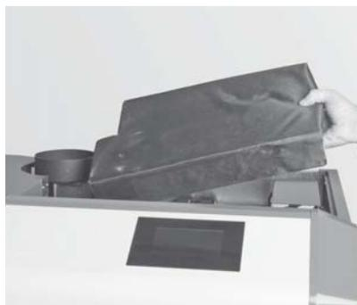
Fig. 88 Rimuovere l'isolamento
