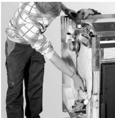
Fig. 11 Posizione della maniglia sul tubo della coclea e sul bocchettone dei gas combusti
