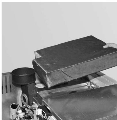
Fig. 25 Rimuovere l'isolamento
