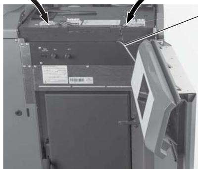
Fig. 90 Agganciare il pannello di comando alla porta (posizione di assistenza), aprire il coperchio
