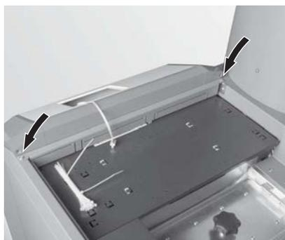
Fig. 89 Allentare le 4 viti del pannello di comando
