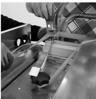
Fig. 13 Fissare la caldaia alla slitta con la cinghia elastica
