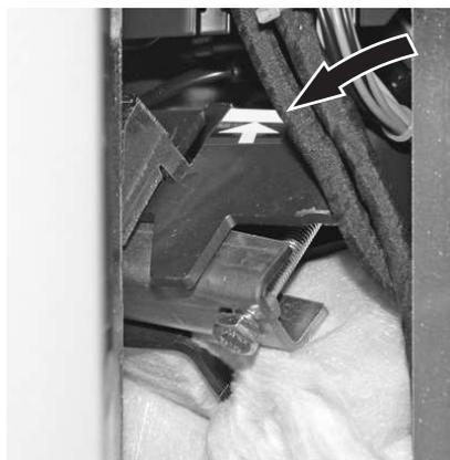
Fig. 37 Avvitare saldamente le viti di fissaggio in alto fino alla battuta (marcatura)
