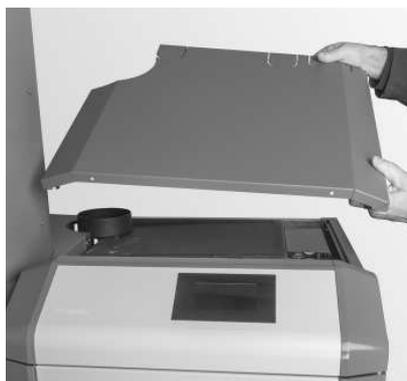
Fig. 70 Applicare il coperchio del rivestimento
