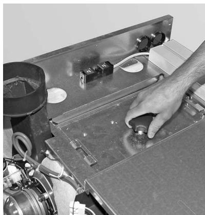
Fig. 26 Rimuovere il collegamento a vite
