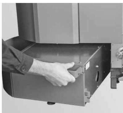
Fig. 72 Inserire il cassetto raccoglienerere spingendolo leggermente inclinato e introdurre completamente la maniglia nel cassetto
