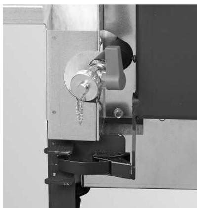
Fig. 24 Avvitare il rubinetto di riempimento e svuotamento (posizione della maniglia a destra) e reinserire la maniglia
