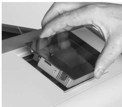
Fig. 67 Inserire InfoWIN Touch nel pannello di comando
