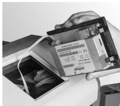
Fig. 66 Infilare il cavo di collegamento di InfoWIN Touch e inserire InfoWIN Touch nel pannello di comando (con il connettore rivolto verso l'alto)
