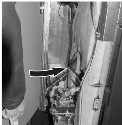
Fig. 35 Infilare la coclea di alimentazione in basso accanto al tubo della coclea
