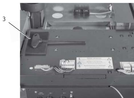
Fig. 80 Incollare il supporto in gomma crepla, vista **senza** regolazione MES INFINITY
