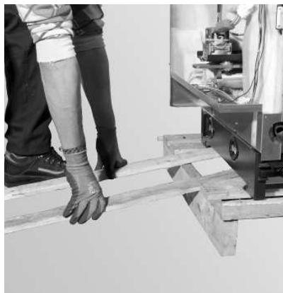
Fig. 10 Collocare le assi della gabbia a mo' di rampa
