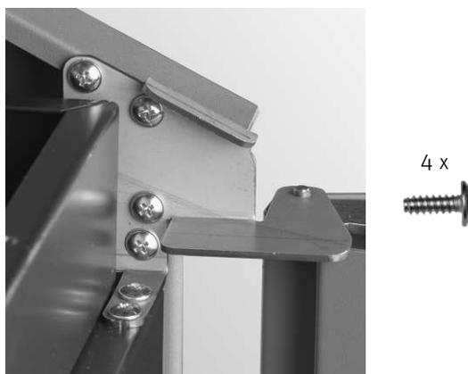
Fig. 64 Serrare la cerniera della porta in alto, avvitare la parete laterale con 4 viti autofilettanti
