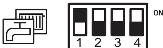
Fig. 60 Posizione interruttori DIP 1 circuito di riscaldamento
