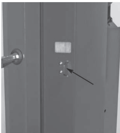
Fig. 42 Registrare lo sportello di rivestimento
