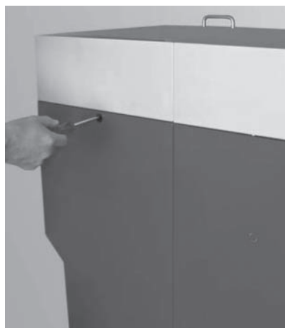
Fig. 73 Togliere la vite di sicurezza
