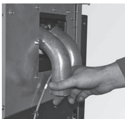
Fig. 32 Innestare gli attacchi dei tubi nella stiva pellets
