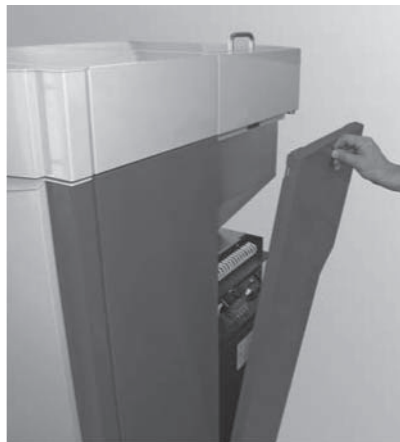
Fig. 60 Agganciare in basso la fiancata posteriore destra e fissarla in alto con la chiusura magnetica
