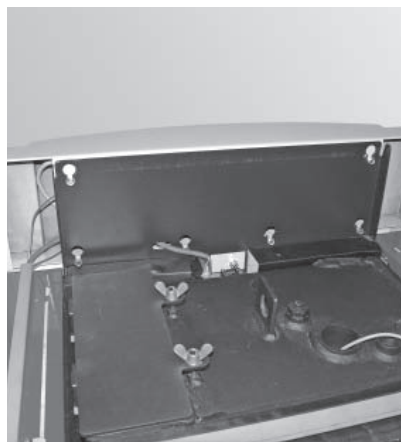
Fig. 49 Avvitare la mascherina alla lamiera di copertura
