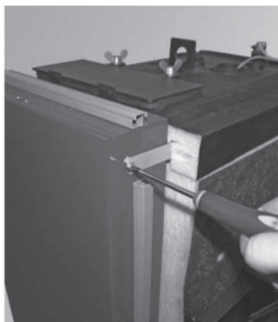
Fig. 36 Fissare in alto ogni fiancata con una vite
