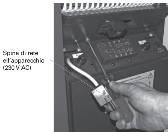
Fig. 72 Staccare la spina di rete dell'apparecchio e togliere la vite
