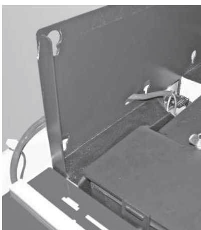
Fig. 46 Posizionare il cavo dell'interruttore di sicurezza dello sportello
