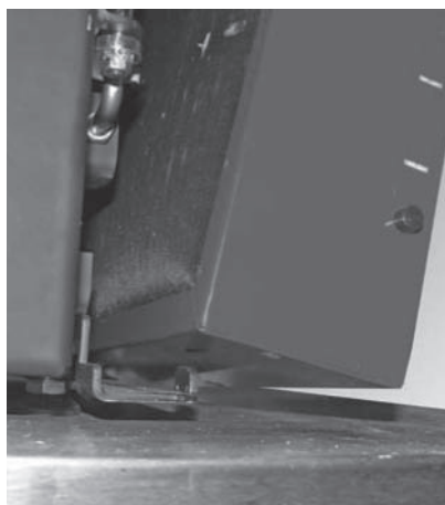
Fig. 35 Innestare le fiancate in basso
