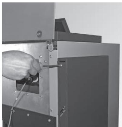
Fig. 30 Fissare la parete laterale sinistra con una vite
