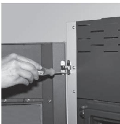
Fig. 31 Inserire la cerniera nella parete laterale
