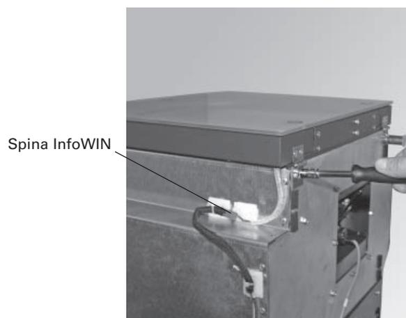
Fig. 21 avvitate 4 volte il coperchio dietro e inserire la spina InfoWIN
