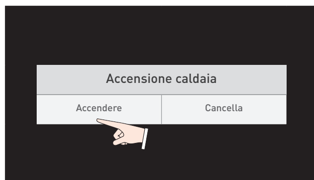
Fig. 53 Conferma accensione caldaia
