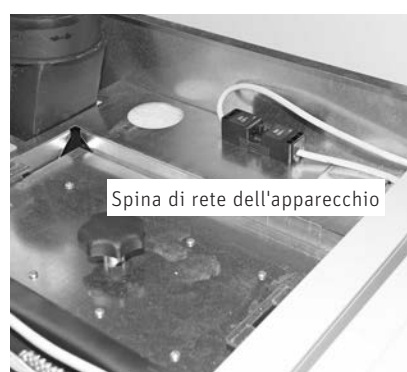
Fig. 97 Spina di rete dell'apparecchio in alto sotto la copertura
