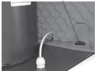
Fig. 139 Rimuovere il tappo del serbatoio acqua
