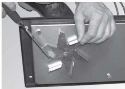
Fig. 136 Pulire le pale del ventilatore
