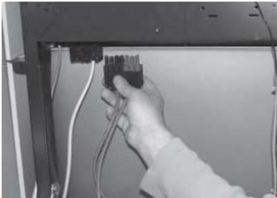
Fig. 132 Scollegare il connettore del ventilatore
