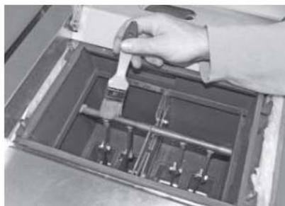
Fig. 135 Pulire le linee di giuntura
